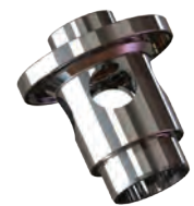
ME840C-16-104 Clásico cabezal del asiento *Diseñado para crear un más alto diferencial de presión y mayor carrera del cabezal del asiento en aplicaciones de bajo flujo, como en bobtails
